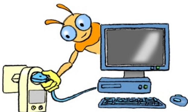
Un wattmètre est un appareil qui permet de mesurer la puissance électrique que soutire à tout moment un appareil électrique ou électronique. La puissance, qui se donne en *watts (W)*, représente l'**énergie électrique consommée à chaque seconde**.
