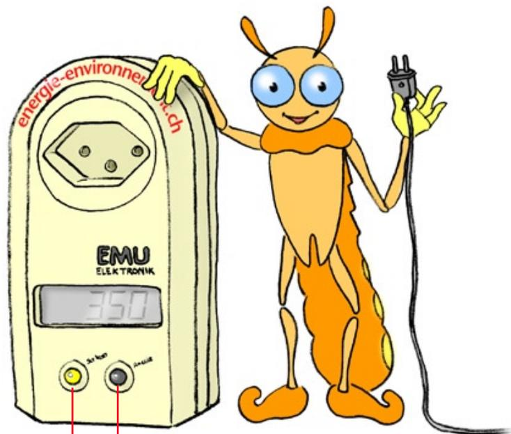
Bouton pour choisir le mode de mesure : la puissance (en watts=W) ou l'énergie totale (en kilowattheure=kWh). On peut aussi afficher le coût de l'énergie consommée en indiquant à l'appareil le prix du kilowattheure.
